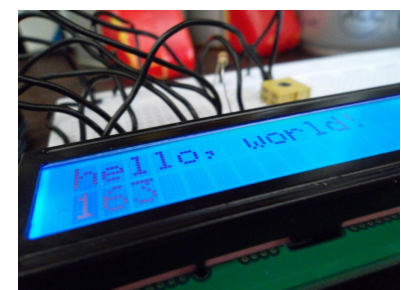
Display LCD Un display LCD 16x2 interfacciato ad Arduino
